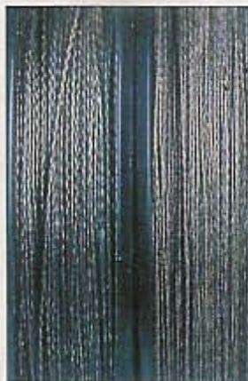
Résistance de 40 kg (à gauche) ou 20 kg (à droite), le tressage est identique.
